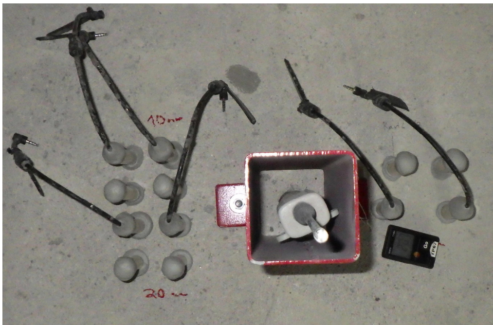
Kuva 1. Esimerkkikuva vertailumittauksista. Kuvan keskellä, punaisen mittaussuojan sisällä eGate anturi, jonka mittaussyvyys on 40 mm. Vertailumittaukset tehtiin em. 40 mm syvyydeltä kahdella rinnakkaisella porareikäällä sekä niiden lisäksi kahdelta mittaussyvyydeltä rakenteen pintaosasta. Kuvan musta mittalaite on vertailumittausten aikana olosuhteita automaattisesti tallentanut tiedonkerääjä.
